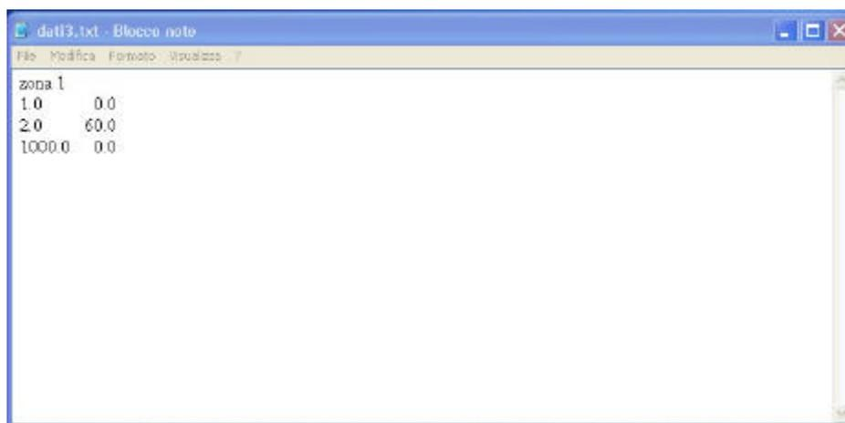
Figura 14 – File ascii di input per la descrizione dell’idrogramma corrispondente ad ogni zona sorgente.
